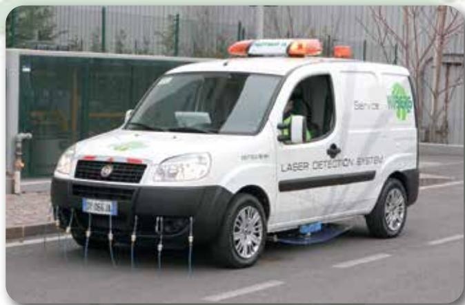
Protheo Compact je sustav koji omogućuje preobrazbu bilo kojeg vozila u vozilo za detekciju propuštanja plina zbog veoma kompaktnog kućišta. Protheo Compact je savršen sustav za detekciju propuštanja plina zahvaljujući velikoj preciznosti pri otkrivanju metana, s preciznošću manjom od 1ppm. Brza reakcija laserske tehnologije omogućuje vozilima da voze brzinom od 40km/h tijekom detekcije propuštanja plina.
